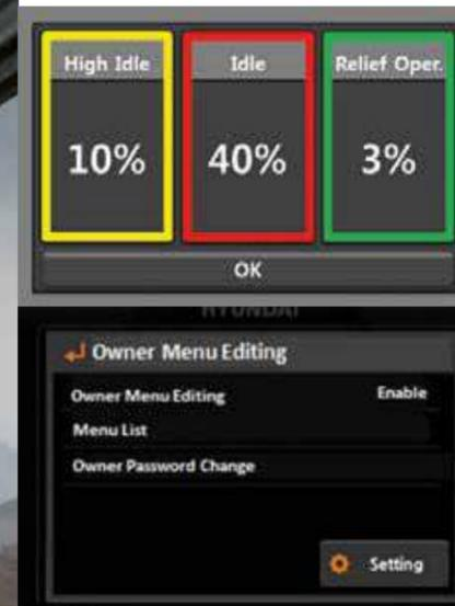
Las **funciones del menú** pueden ser ajustadas por el propietario de la máquina, quien también puede proporcionar o restringir el acceso para los usuarios de la máquina al usar una contraseña para bloquear o desbloquear la lista de parámetros de la máquina.
