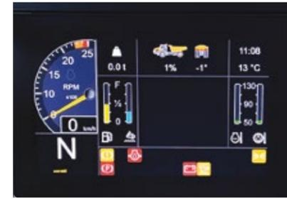
L'écran multifonction d'entretien et de maintenance permet de contrôler facilement le niveau d'huile de transmission, ainsi que les composants hydrauliques et électroniques.
