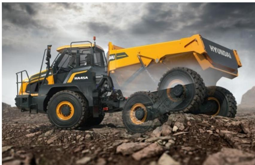
Les différentiels avant et arrière sont à glissement limité, tandis que le différentiel longitudinal peut être verrouillé manuellement.
