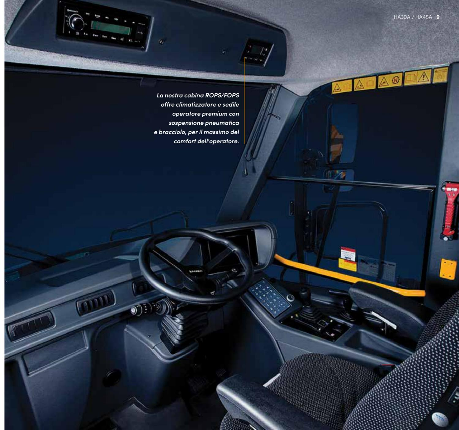
La nostra cabina ROPS/FOPS offre climatizzatore e sedile operatore premium con sospensione pneumatica e bracciolo, per il massimo del comfort dell'operatore.
