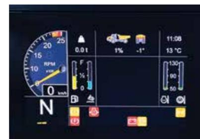
Il display multifunzionale di assistenza e manutenzione semplifica il controllo del livello olio cambio, anche dei componenti idraulici ed elettronici.
