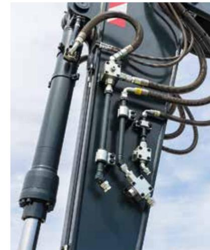
**Hydraulique auxiliaire proportionnelle**
