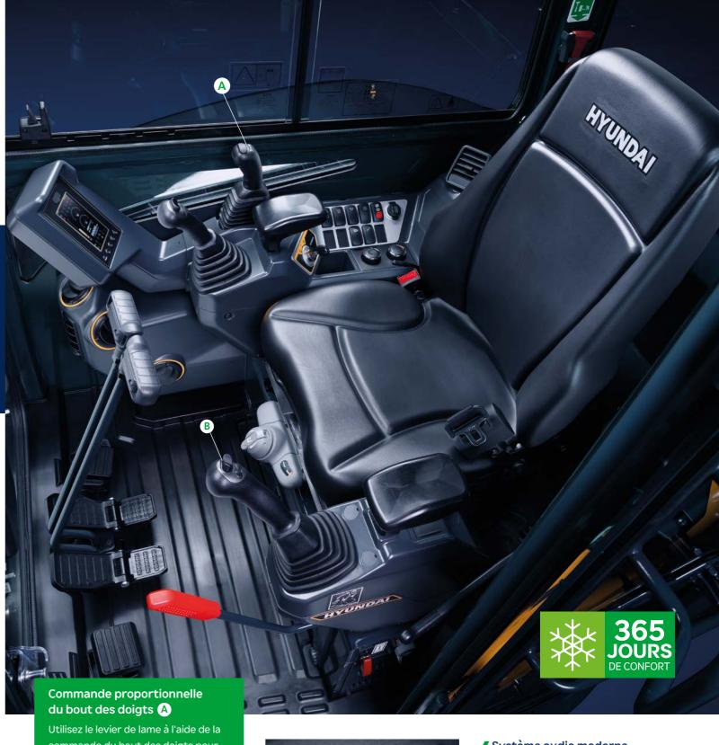
Utilisez le levier de lame à l'aide de la commande du bout des doigts pour définir la vitesse de conduite parfaite lors du nivellement.
