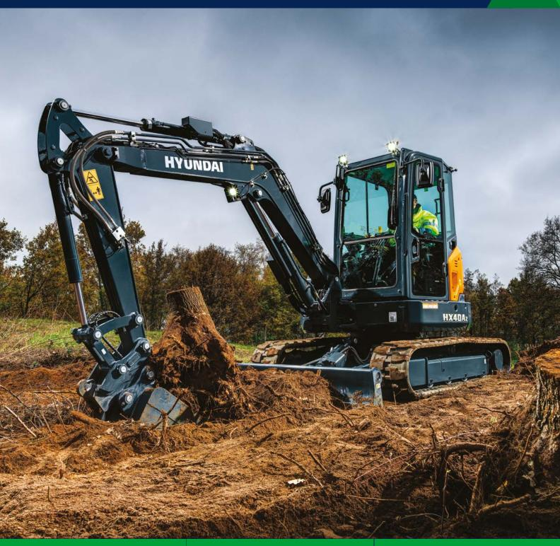
Puissance du moteur 24,8 ch (18,5 kW) – 39,0 ch (29,1 kW) Capacité du godet 0,11 - 0,15 m³ Poids opérationnel 3880 – 5030 kg
