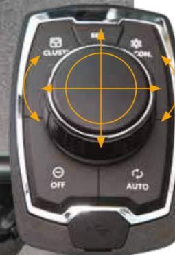
L'acceleratore, il dispositivo di controllo dell'aria condizionata e il quadro strumenti possono essere azionati utilizzando il comodo **dispositivo di controllo** di tipo jog shuttle.
