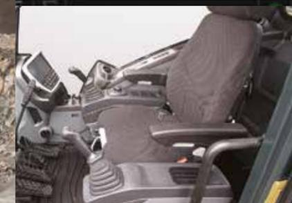
HX220AL è dotato come standard di un lussuoso **sedile con sospensione pneumatica e riscaldamento**. I **joystick ergonomici** rendono l'azionamento confortevole e intuitivo.
