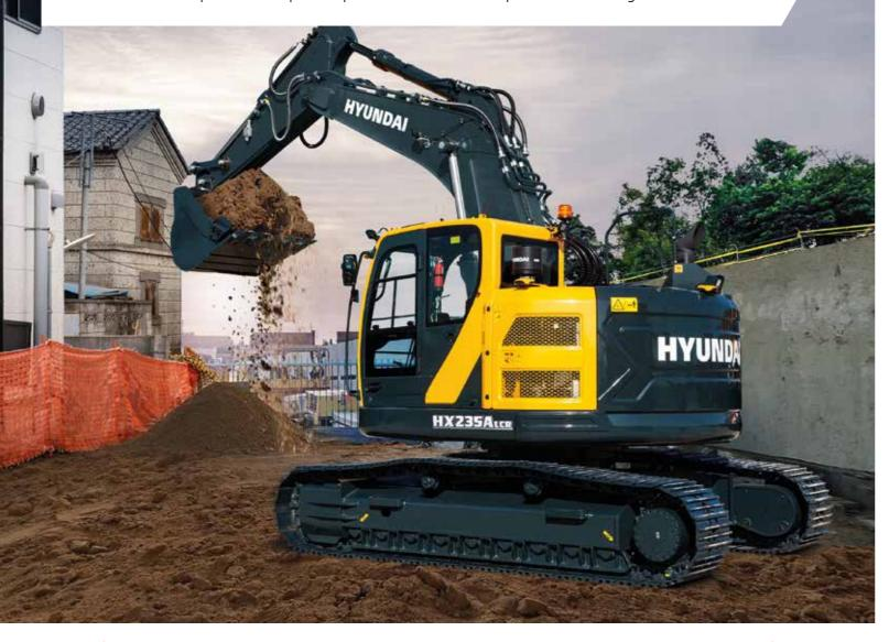
La HX235A LCR (à rayon compact) bénéficie d'un déport arrière court et d'un contrepoids courbe qui évolue en surplomb minimum le long des chenilles. Grâce au déport arrière réduit de la machine, les opérateurs peuvent travailler l'esprit tranquille lorsqu'ils interviennent dans des espaces restreints. La réduction du risque de contact avec des murs ou obstacles à proximité accroît également la durabilité de la machine.
