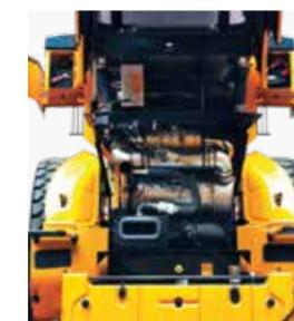
El **capó abatible es totalmente retráctil** y puede **abrirse eléctricamente** para facilitar el acceso al compartimento del motor sellado y al compartimento de refrigeración. El compartimento del motor está diseñado para evitar la posibilidad de incendio a causa de la entrada de cuerpos extraños.
