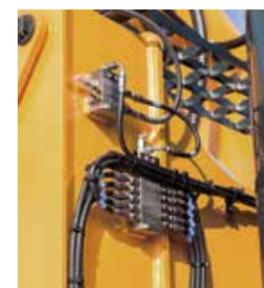
Con el **sistema de engrase automático** opcional, la grasa se aplica a los puntos de lubricación automáticamente cuando se necesita. Se asegura la dosificación correcta y se aplica el lubricante de manera uniforme, reduciendo el consumo de grasa y eliminando los residuos.
