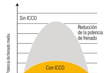
La función de **corte de embrague inteligente (ICCO)** minimiza la pérdida de potencia en el convertidor de par y evita el uso excesivo de potencia durante el frenado. Esto reduce la generación de calor y el desgaste del disco de freno.
