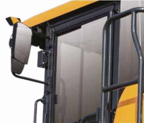
El **espejo lateral** es fácil de ajustar para una visibilidad óptima y se puede plegar para evitar daños durante el transporte.
