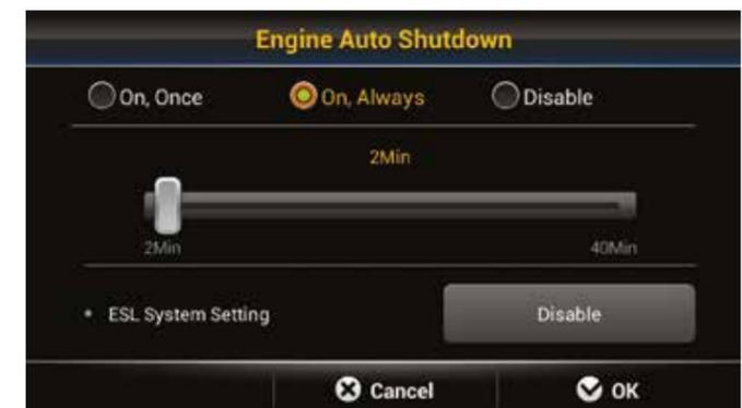
El motor **se apaga automáticamente cuando la máquina está en reposo** para reducir el consumo de combustible y evitar emisiones innecesarias. Se pueden seleccionar diferentes modos de funcionamiento y tiempos de inactividad según el entorno de trabajo, lo que aumenta aún más la eficiencia.
