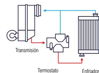
El **termostato opcional para la refrigeración de la transmisión** ayuda a calentar el líquido rápidamente y lo mantiene a la temperatura óptima de trabajo, protegiendo los componentes y aumentando la eficiencia.
