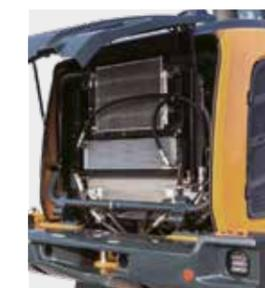
La HL955A tiene un fiable **enfriador de aire de núcleo ancho y aletas** que evita la degradación del rendimiento causada por la contaminación.
