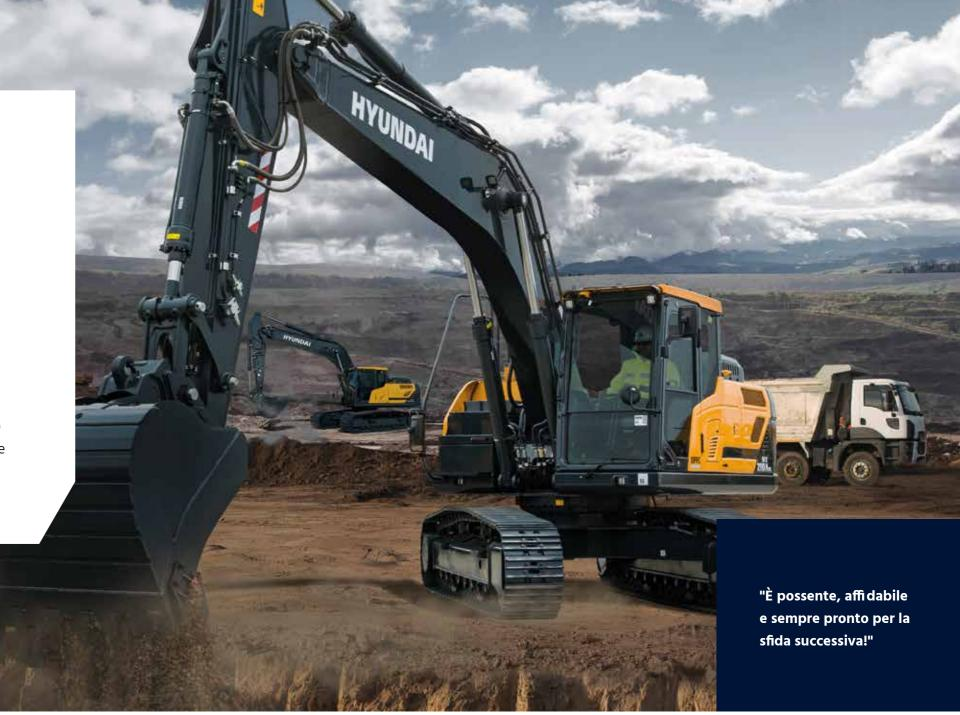
Il sottocarro è potenziato con nove rulli inferiori. Oltre a ottimizzare la stabilità, riducono l'usura dei cingoli e il rischio di scarrellamento e dei conseguenti danni ai cingoli.
