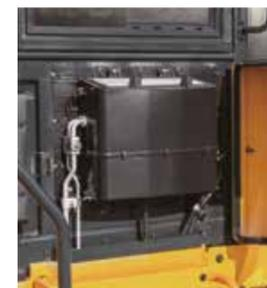
Le **filtre de climatisation** est facile à remplacer. Il est conçu dans un matériau sélectionné spécifiquement pour offrir des performances supérieures.
