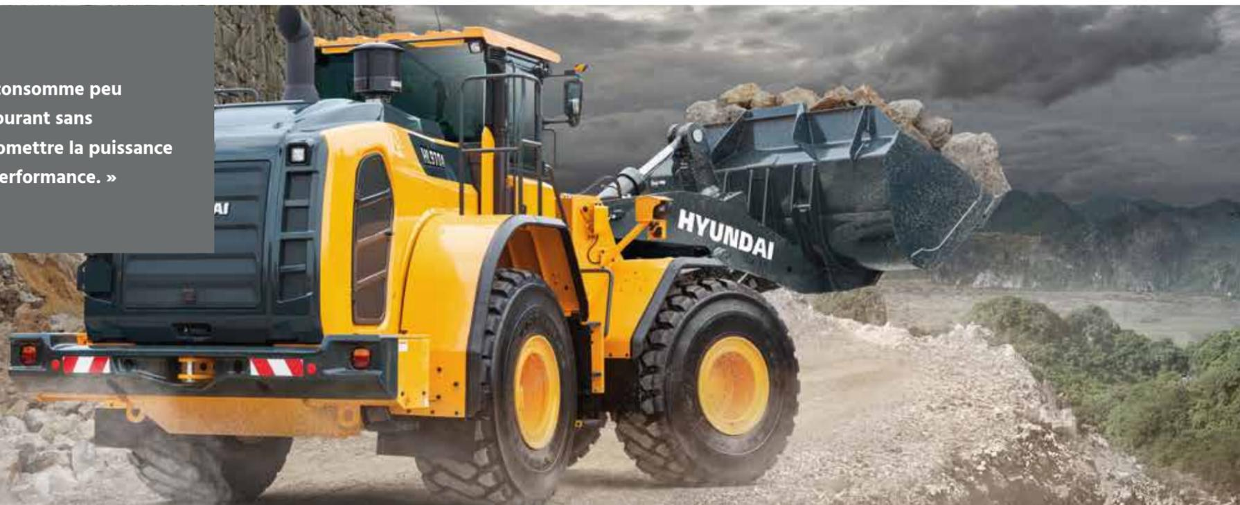
La HL970A est équipée d'une **transmission à cinq vitesses avec embrayage de verrouillage**, permettant de travailler plus efficacement tout en réduisant la consommation de carburant et les émissions.
