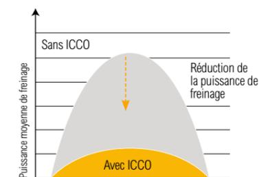
La fonction de **coupure d'embrayage intelligente (ICCO)** réduit la perte de puissance dans le convertisseur de couple ainsi que la consommation d'énergie excessive durant le freinage. Elle réduit la production de chaleur et l'usure sur le disque de frein.
