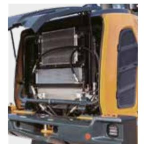
La HL970A dispose d'un **radiateur d'air à large noyau et à ailettes** fiable qui empêche la réduction des performances causée par la contamination.
