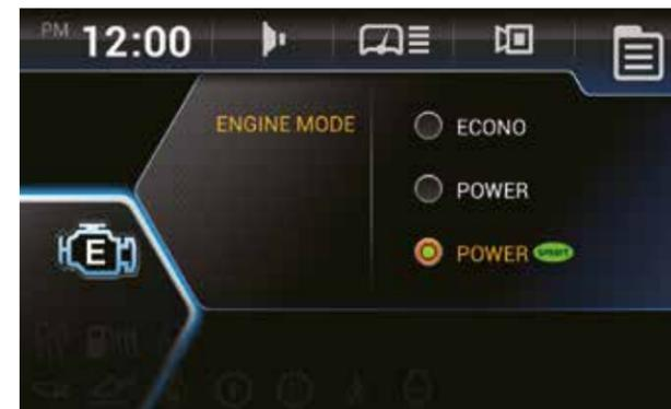
Le nouveau **mode Smart Power** règle le régime moteur lors de travaux lourds tels que l'excavation pour permettre d'économiser du carburant sans compromettre les performances. La technologie permet aussi d'obtenir un bon équilibre entre force de traction et force d'arrachement.
