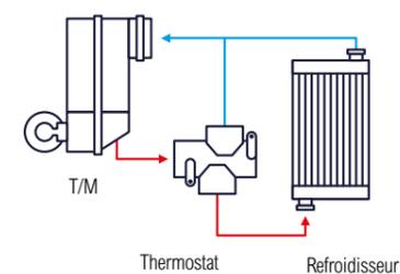
La HL970A est équipée d'un **thermostat pour le refroidissement de la transmission**. Il permet de chauffer rapidement le liquide et de le conserver à une température de fonctionnement optimale, en protégeant les composants et en augmentant leur efficacité.
