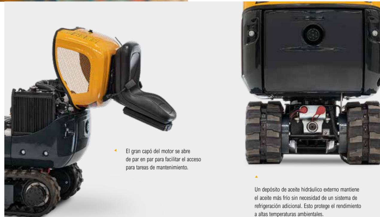
El gran capó del motor se abre de par en par para facilitar el acceso para tareas de mantenimiento.
