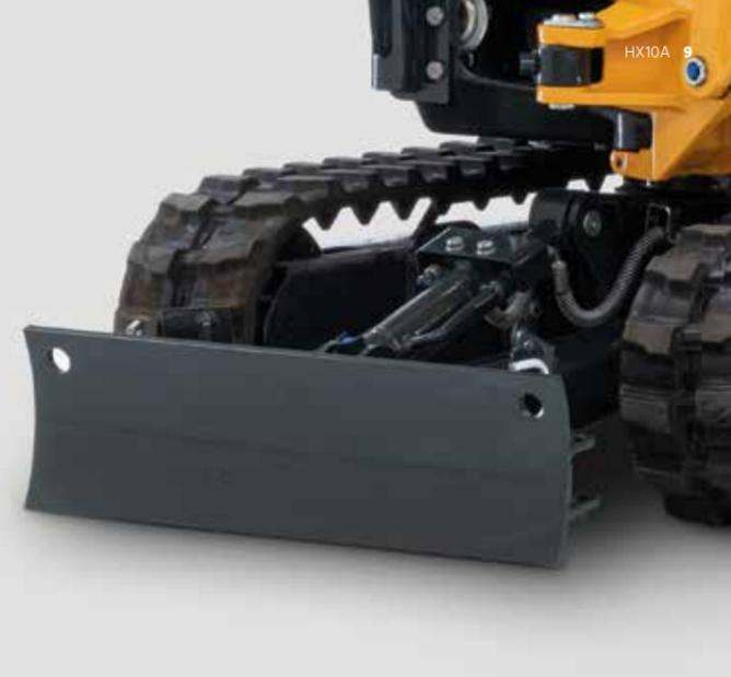
La hoja niveladora extensible permite nivelar en todo el ancho de la oruga.
