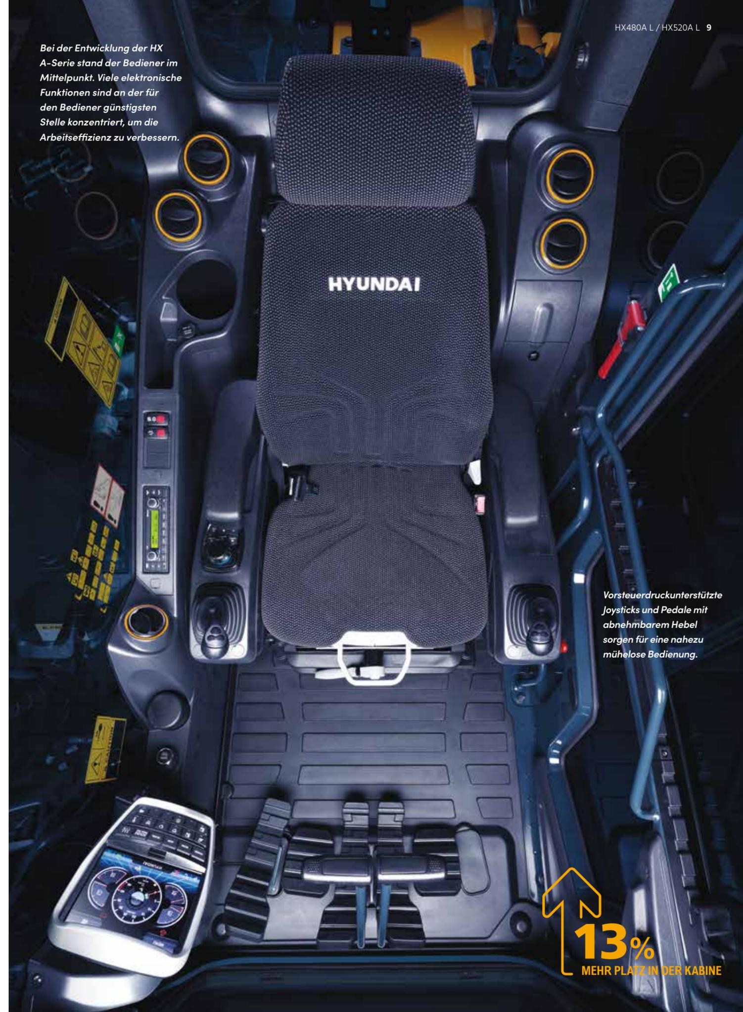
Vorsteuerdruckunterstützte Joysticks und Pedale mit abnehmbarem Hebel sorgen für eine nahezu mühelose Bedienung.
