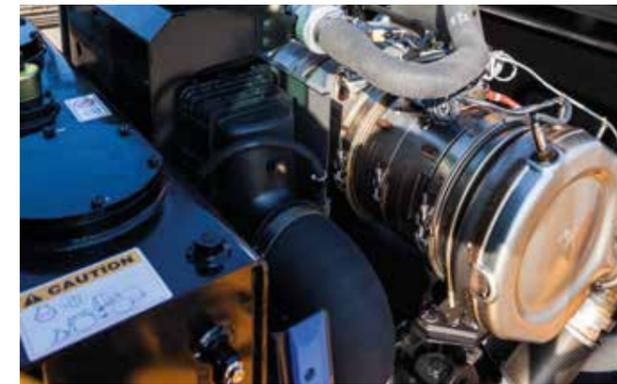
Comme toutes les machines de la Série A, la HL 955A est équipée de notre **système tout-en-un de post-traitement des gaz d'échappement** qui réduit les émissions et les coûts d'exploitation tout en améliorant la fiabilité et en simplifiant la maintenance.
