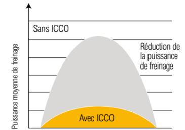
La fonction d'**interruption intelligente d'embrayage (ICCO)** réduit la perte de puissance dans le convertisseur de couple ainsi que la consommation d'énergie excessive durant le freinage. Elle réduit la production de chaleur et l'usure sur le disque de frein.
