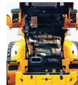
Le **capot moteur basculant vers l'arrière est entièrement rétractable** et peut être **ouvert électriquement** pour faciliter l'accès au compartiment moteur étanche et à la chambre de refroidissement. Le compartiment moteur est conçu de sorte à éviter tout risque de feu causé par l'entrée de corps étrangers.
