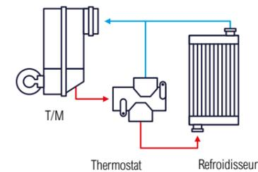
Le **thermostat pour le refroidissement de la transmission** en option permet de chauffer rapidement le liquide et de le conserver à une température de fonctionnement optimale, en protégeant les composants et en augmentant leur efficacité.
