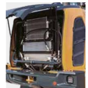
La HL955A dispose d'un **radiateur d'air à large noyau et à ailettes** fiable qui empêche la réduction des performances causée par la contamination.
