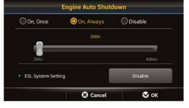
El motor se apaga automáticamente cuando la máquina está en reposo para reducir el consumo de combustible y evitar emisiones innecesarias. Se pueden seleccionar diferentes modos de funcionamiento y tiempos de inactividad según el entorno de trabajo, lo que aumenta aún más la eficiencia.
