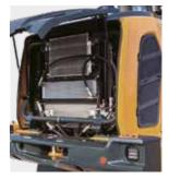
La HL970A tiene un fiable enfriador de aire de núcleo ancho y aletas que evita la degradación del rendimiento causada por la contaminación.
