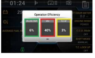
El **panel de instrumentos** está optimizado para proporcionar un acceso rápido y fácil a la información sobre el estado de la máquina a medida que usted trabaja. Cuenta con un monitor de pantalla táctil de siete pulgadas que ofrece una legibilidad excelente.
