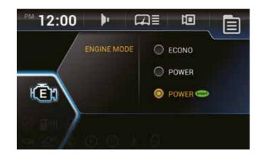
El nuevo **modo Smart Power** ajusta las revoluciones del motor en trabajos de carga pesada, como la excavación, para ahorrar combustible sin comprometer el rendimiento. La tecnología también logra un equilibrio óptimo entre las fuerzas de tracción y arranque.
