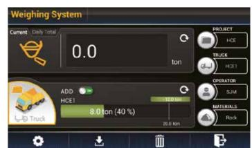
El sistema de pesaje acumulativo automático/manual de alta precisión le ayuda a gestionar la producción de manera más eficiente en cualquier entorno. Para garantizar la máxima precisión, en el monitor se muestran iconos de error de pesaje y un indicador de valor de peso de dos colores.
