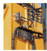
Con il sistema di ingrassaggio automatico optional, il grasso è applicato automaticamente ai punti di lubrificazione quando serve. Il dosaggio corretto è garantito e il lubrificante è applicato uniformemente con riduzione nel consumo del grasso ed eliminazione degli sprechi.
