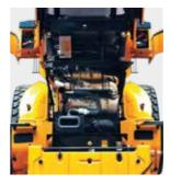
Il cofano motore inclinabile all'indietro è completamente retrattile e può essere aperto elettricamente per un accesso agevolato a vano motore e di raffreddamento sigillati. Il vano motore è progettato per prevenire il rischio di incendi causati dall'afflusso di materiale esterno.
