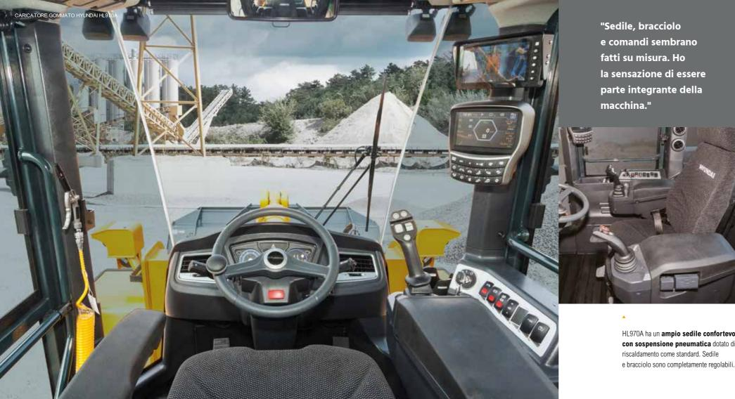
HL970A ha un ampio sedile confortevole con sospensione pneumatica dotato di riscaldamento come standard. Sedile
