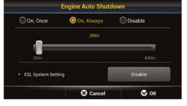
Per tagliare il consumo di carburante ed evitare emissioni inutili, il **motore** si spegne automaticamente quando la macchina è a riposo.
