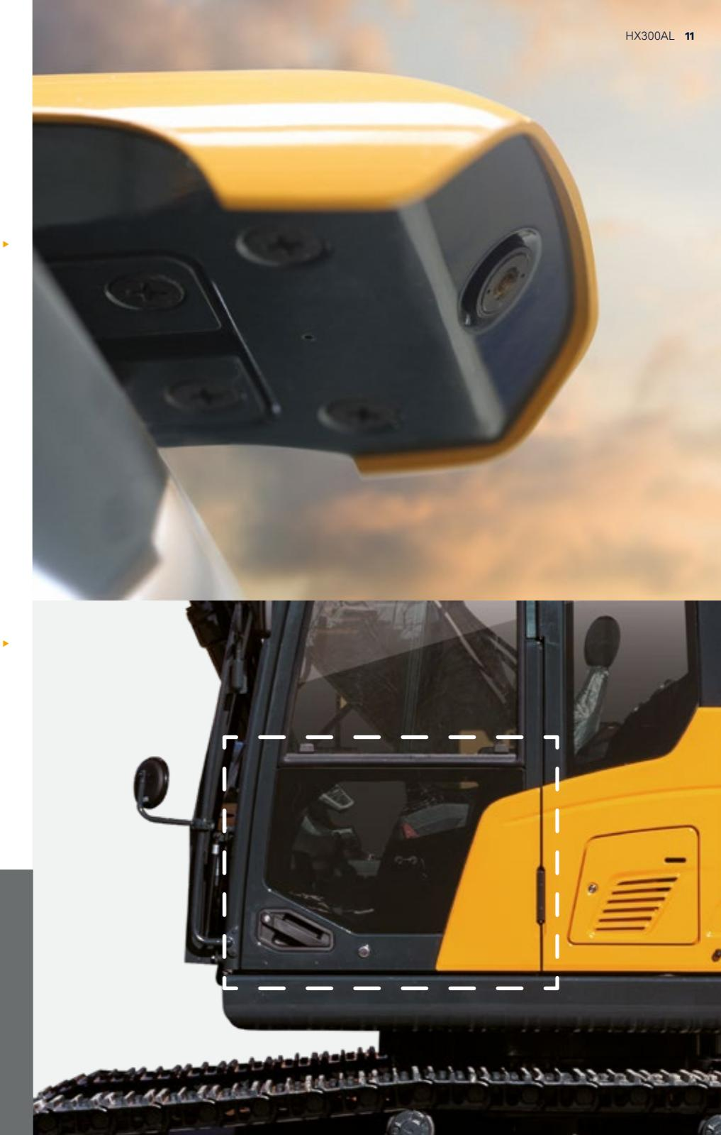
Die **automatische Sicherheitssperre** verhindert unbeabsichtigte Zündung. Während der Aktivierung der automatischen Sicherheitssperre wird der Bagger nicht über den RCV-Hebel gesteuert.
