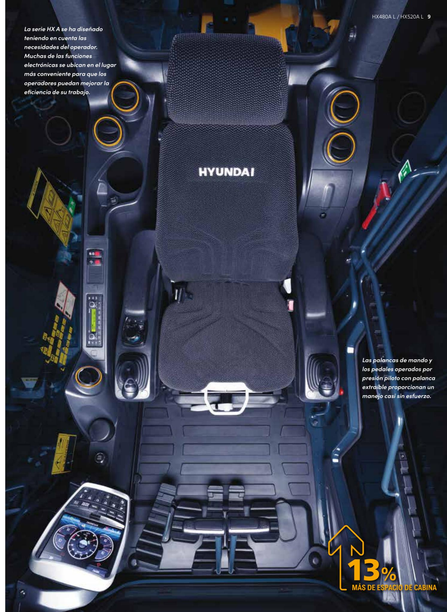
Las palancas de mando y los pedales operados por presión piloto con palanca extraíble proporcionan un manejo casi sin esfuerzo.
