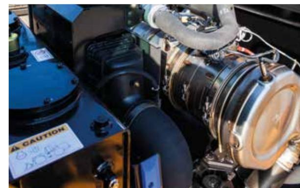
Come tutte le macchine targate Serie A, HL955A è dotato di **sistema di post-trattamento dello scarico tutto in uno** che riduce emissioni e costi di esercizio e nello stesso tempo aumenta l'affidabilità e semplifica la manutenzione.
