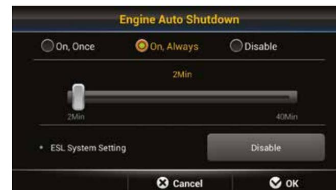
Per tagliare il consumo di carburante ed evitare emissioni inutili, il **motore si spegne automaticamente quando la macchina è a riposo**. Per aumentare ulteriormente l'efficienza, possono essere selezionate diverse modalità operative e tempi al minimo in base all'ambiente di lavoro.
