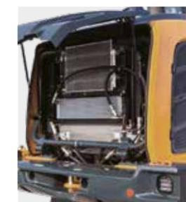
HL955A è dotato di un affidabile **radiatore ad aria ad ampio nucleo e ad alette** che previene la degradazione delle prestazioni causata dalla contaminazione.
