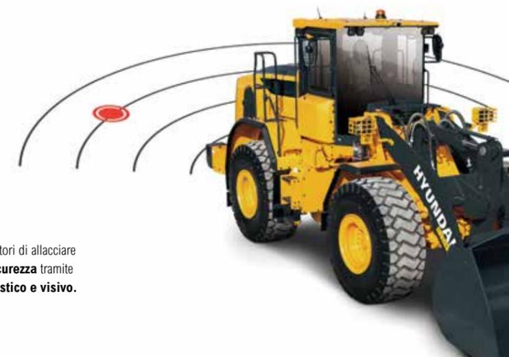
Avviso agli operatori di allacciare la **cintura di sicurezza** tramite un **allarme acustico e visivo**.
