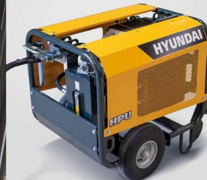
▲ Oltre al motore diesel integrato, il modello HX10A può anche essere alimentato con un'unità elettro-idraulica opzionale, che garantisce funzionamento poco rumoroso e senza emissioni. Questa caratteristica rende l'apparecchiatura ideale per i lavori in aree interne o in ambienti sensibili. Il generatore viene semplicemente connesso al telaio e non influisce sul maneggio o sulle prestazioni della macchina, perfino durante l'azionamento del demolitore.
