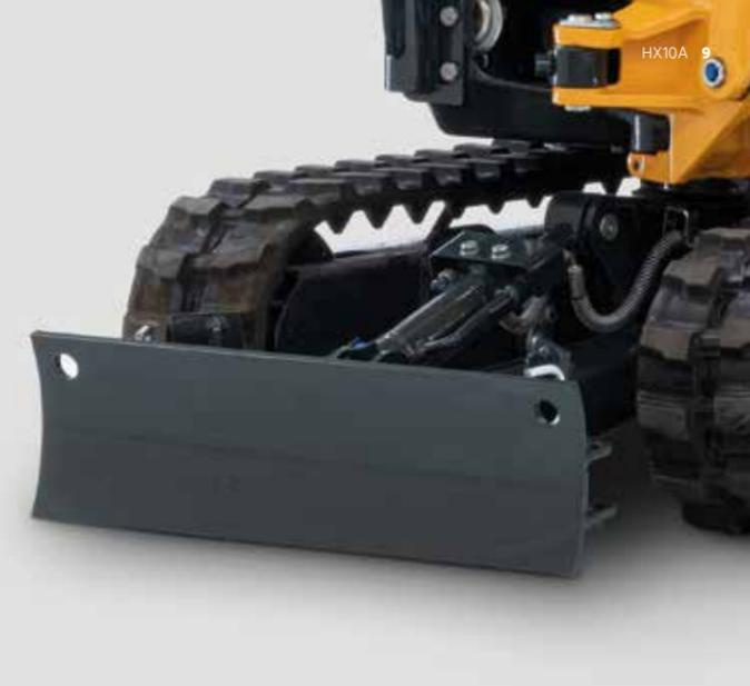
La lama dozer estendibile permette il livellamento lungo l'intera larghezza del cingolo.
