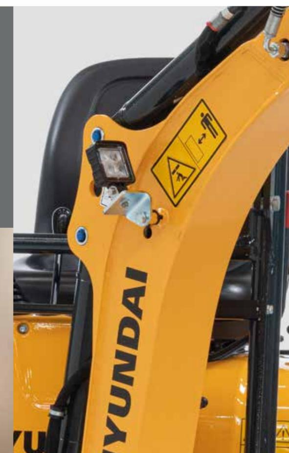
Una potente luce da lavoro garantisce una buona visibilità quando si aziona l'apparecchiatura all'interno o di notte.
